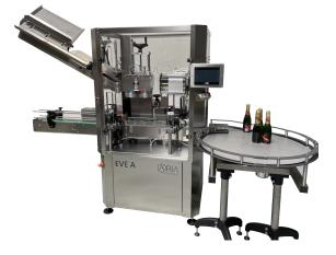
L'étiqueteuse EVE A intègre un distributeur automatique de coiffe, une orientation automatique de coiffe et un cycle d'habillage automatique de 3 postes (étiquette, contre étiquette et collerette).
